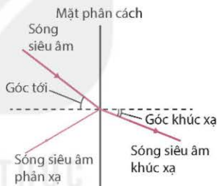
Hình 7.3. Một sóng siêu âm khi chạm vào ranh giới giữa hai vật liệu khác nhau, vừa bị khúc xạ vừa bị phản xạ
