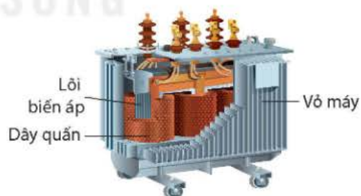
Hình 3.2. Mô tả một số bộ phận của máy biến áp
