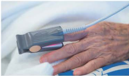
a) Cảm biến đo nồng độ oxygen trong máu ứng dụng trong y tế
