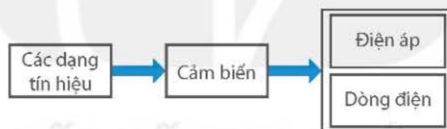
Hình 7.1 Cảm biến chuyển đổi trực tiếp các dạng tín hiệu thành tín hiệu điện
