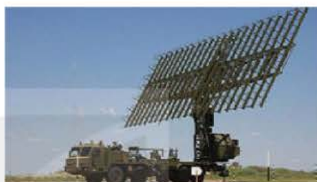
Hình 3.4. Tổ hợp radar cơ động Sopka của Nga sản xuất năm 2014, giúp phát hiện các mục tiêu khí động lực học và đạn đạo ở độ cao trung bình và độ cao lớn
