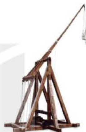
Hình 3.1. Máy bắn đá Trebuchet thế kỉ XII hoạt động bằng nguyên lý cơ học về lực đòn bẩy
