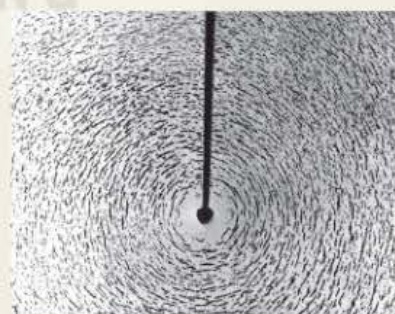
Hình 14.7. Hình ảnh các hạt sắt phân bố xung quanh dòng điện thẳng
