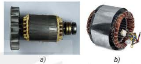
Hình 17.5. Rôto (a) và stato (b) của máy phát điện xoay chiều
