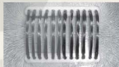
Hình 14.6. Hình ảnh các hạt sắt phân bố bên trong và bên ngoài ống dây mang dòng điện
