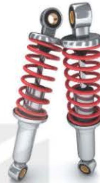
Hình 6.2. Bộ phận giảm xóc của xe máy
