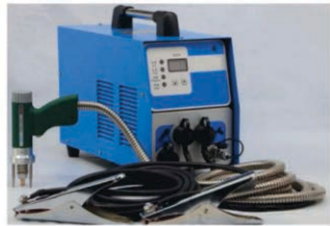
Hình 21.10. Một máy hàn bu-lông sử dụng bộ tụ điện trong khoảng từ 13 750 \mu\text{F} đến 110 000 \mu\text{F}
