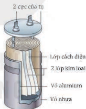
Hình 21.5. Cấu tạo của tụ điện hình trụ
