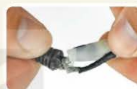
c) Dây điện bị sờn
