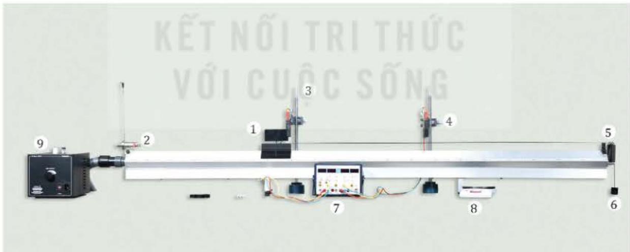
Hình 15.2. Thí nghiệm minh họa định luật 2 Newton
