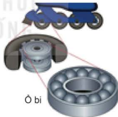
Hình 18.6. Con lăn hoặc ô bi đặt xen giữa vào hai mặt tiếp xúc
