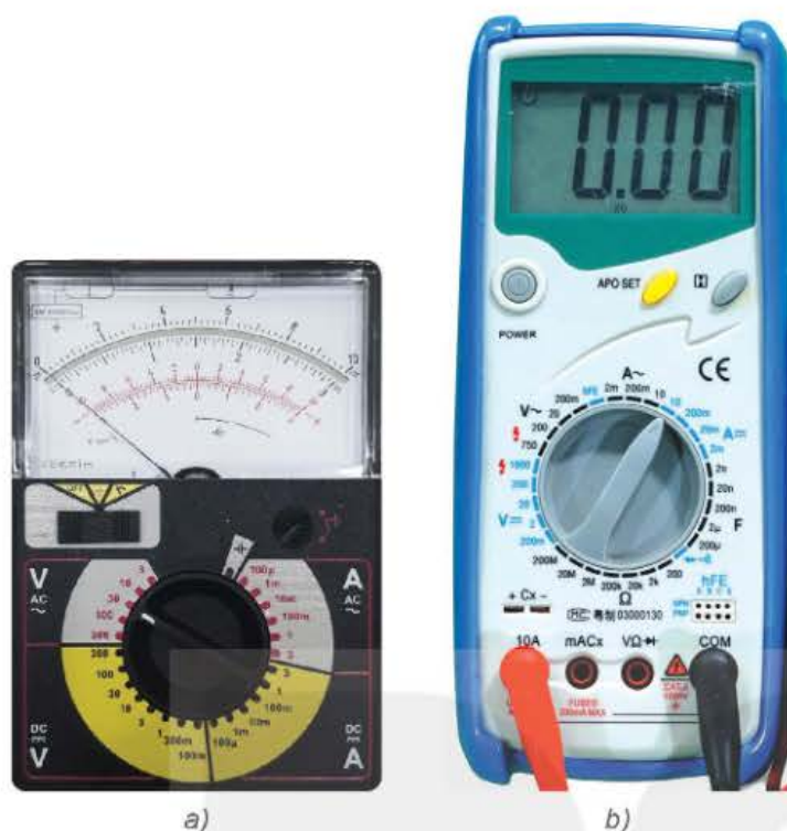
Hình 2.6. Đồng hồ đo điện đa năng kim khung quay a) và đồng hồ đo điện đa năng hiển số b)
