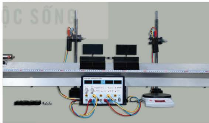
Hình 30.3. Thí nghiệm xác định động lượng trong trường hợp va chạm đàn hồi
