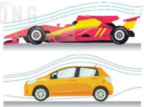
Hình 19.7. Các nhà sản xuất ô tô thường xuyên nghiên cứu và cải tiến để xe có hình dạng khí động học sao cho lực cản nhỏ nhất
